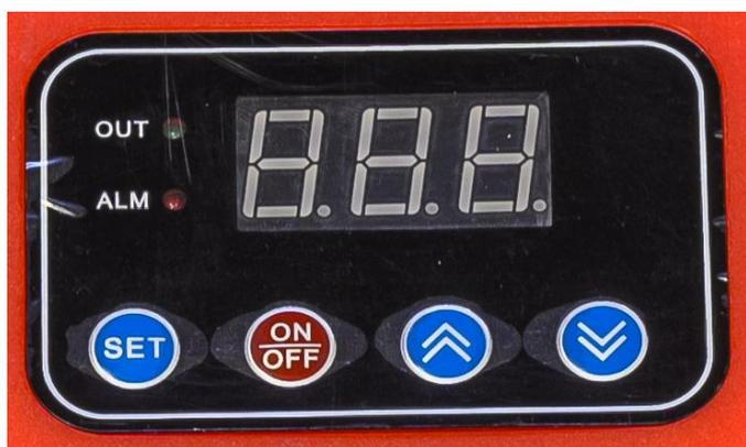
При включённом нагревательном элементе на дисплее отображается текущее значение температуры.
